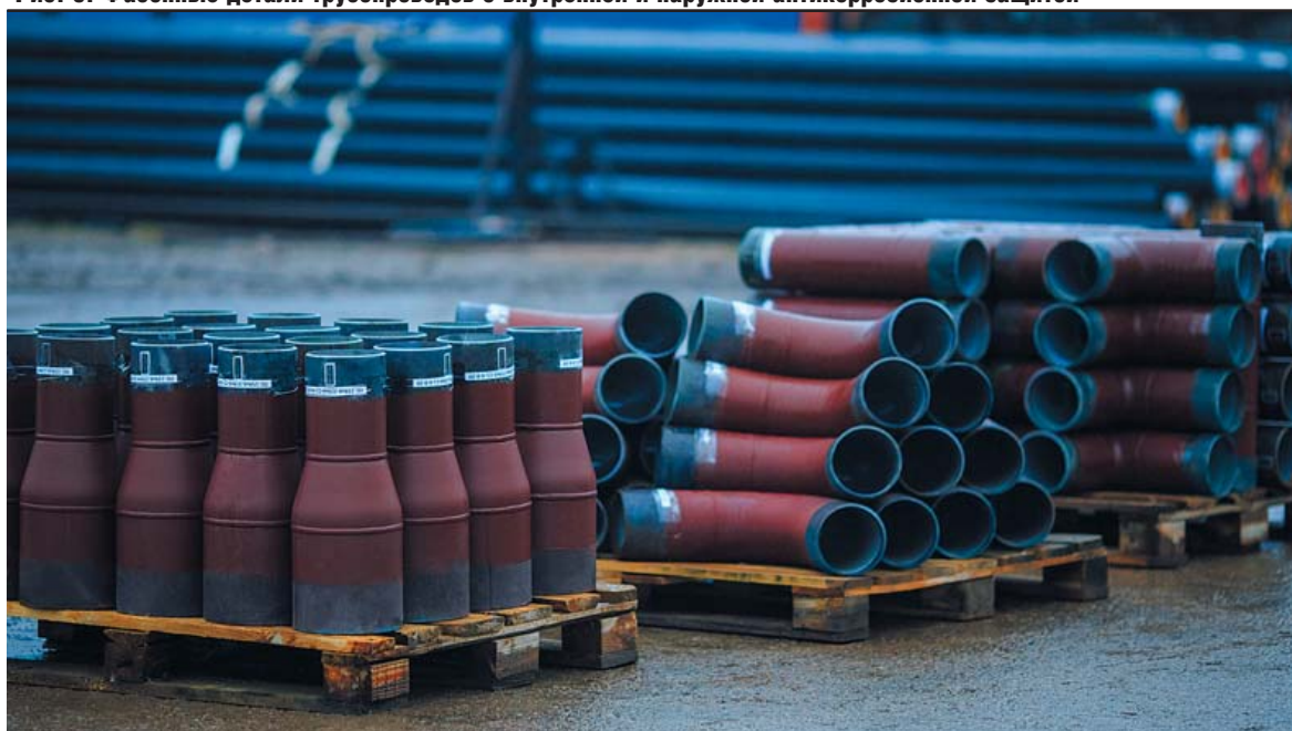
Рис. 5. Фасонные детали трубопроводов с внутренней и наружной антикоррозионной защитой
